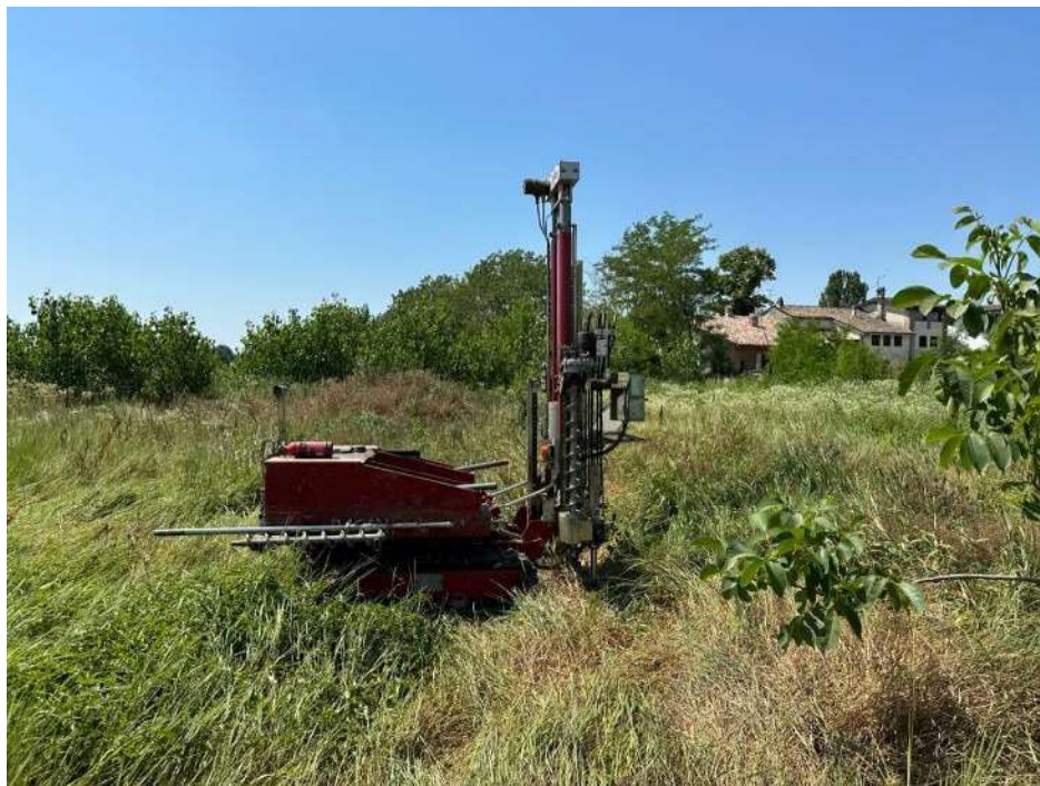
Figura 24: Postazione prova DPSH 03
