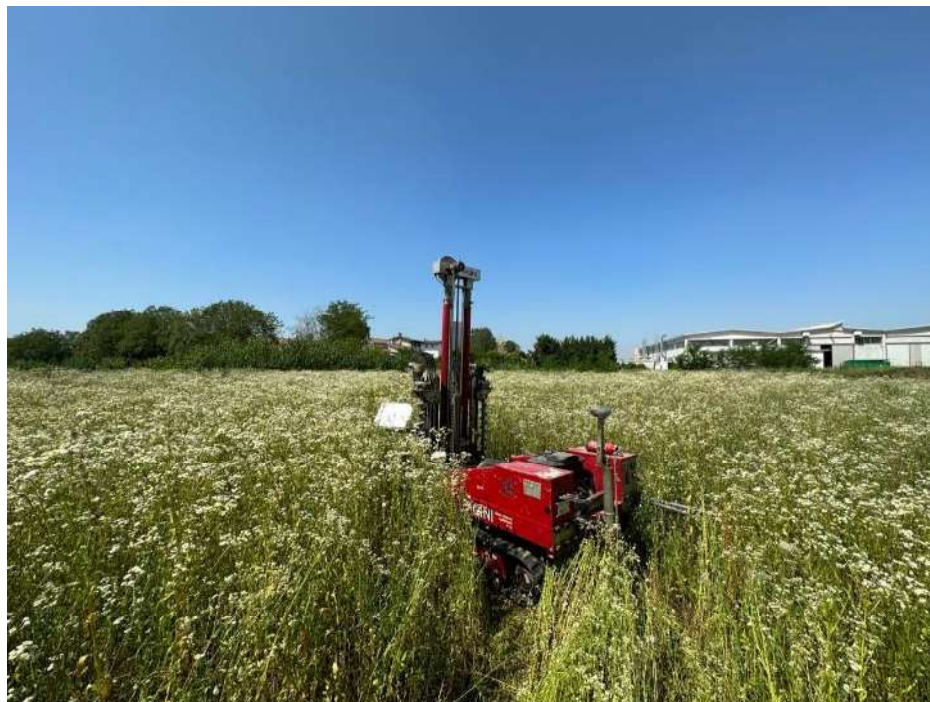
Figura 17: Ubicazione prove penetrometrica statica CPT
