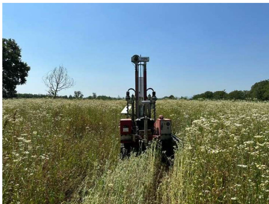
Figura 25: Postazione prova DPSH 04
