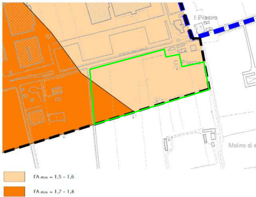
Figura 13: Carta della microzonazione sismica del Comune di Gragnano Trebbiese - Livello 2 - FA SA1 0.1-0.5
