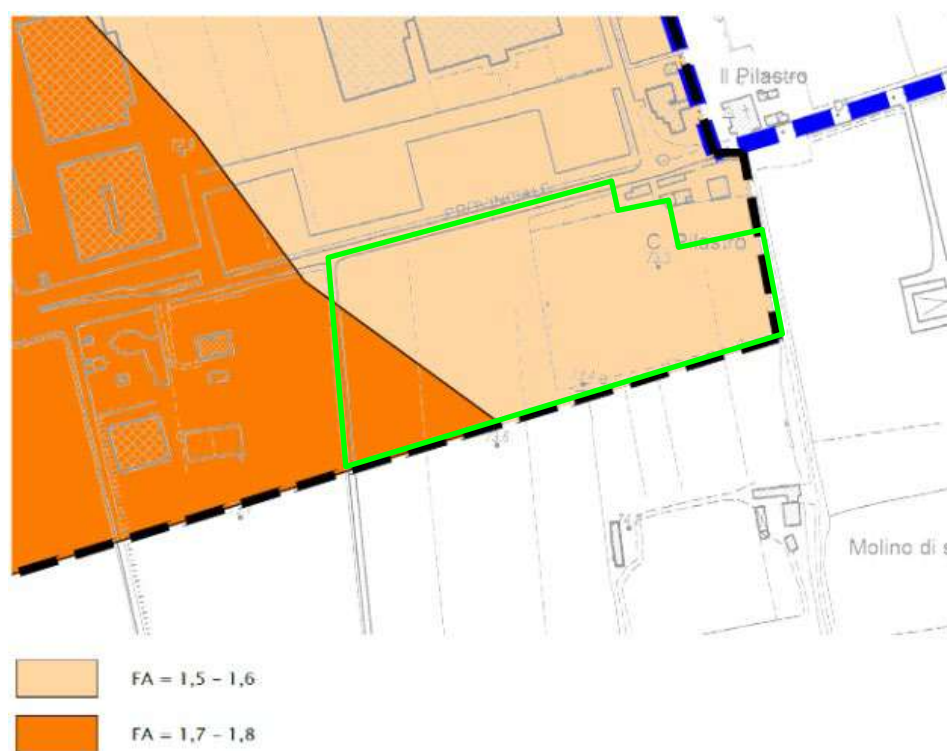
Figura 16: Carta della microzonazione sismica del Comune di Gragnano Trebbiense - Livello 2 - FA S1 0.1-0.5
