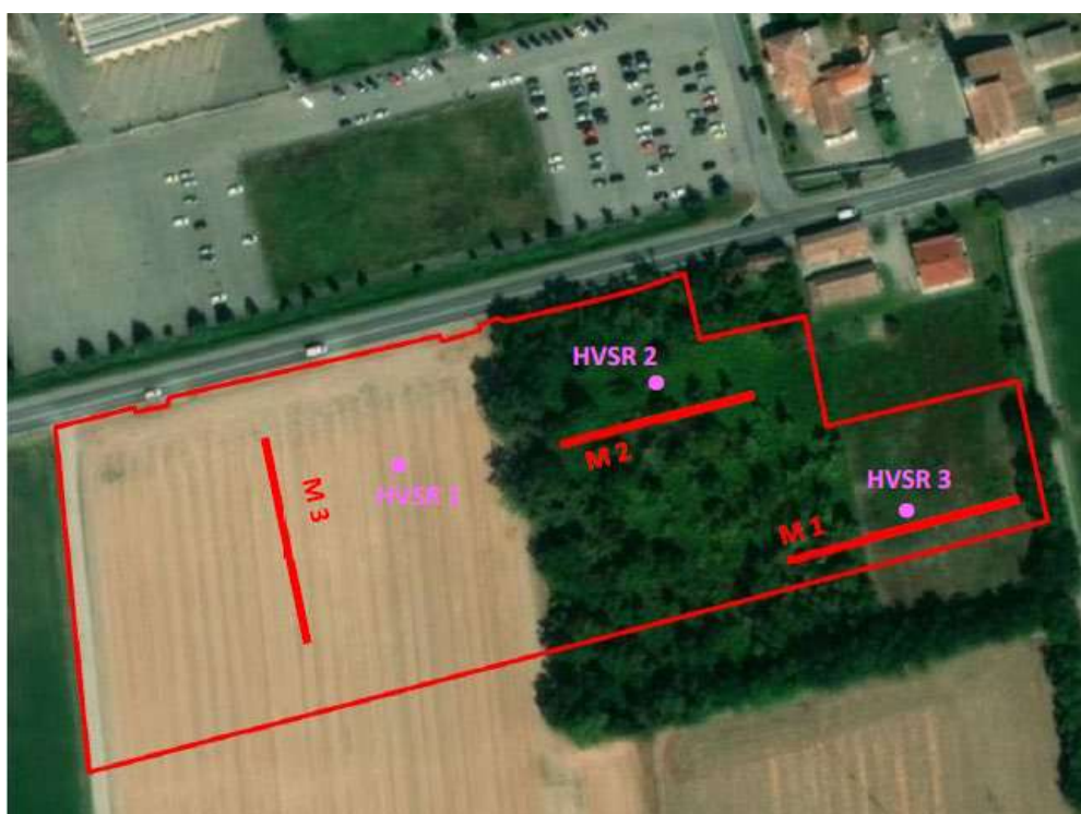
Figura 7: Ubicazione delle prove sismiche
