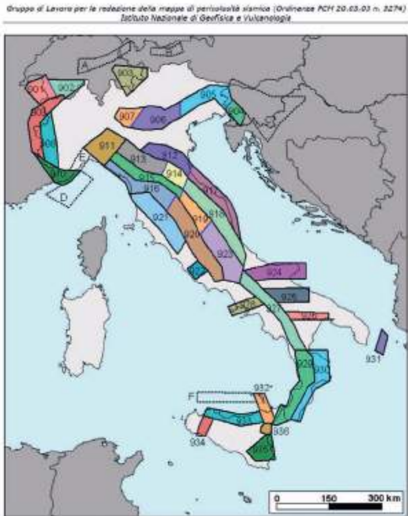
Figura 2 - Zonazione sismogenetica ZS9. Le diverse zone sono individuate da un numero; le zone indicate con una lettera non sono state utilizzate per la valutazione della pericolosità sismica. Il significato del colore (blu o nero) dei bordi delle zone è spiegato nel testo. Il colore delle zone non è invece significativo.
