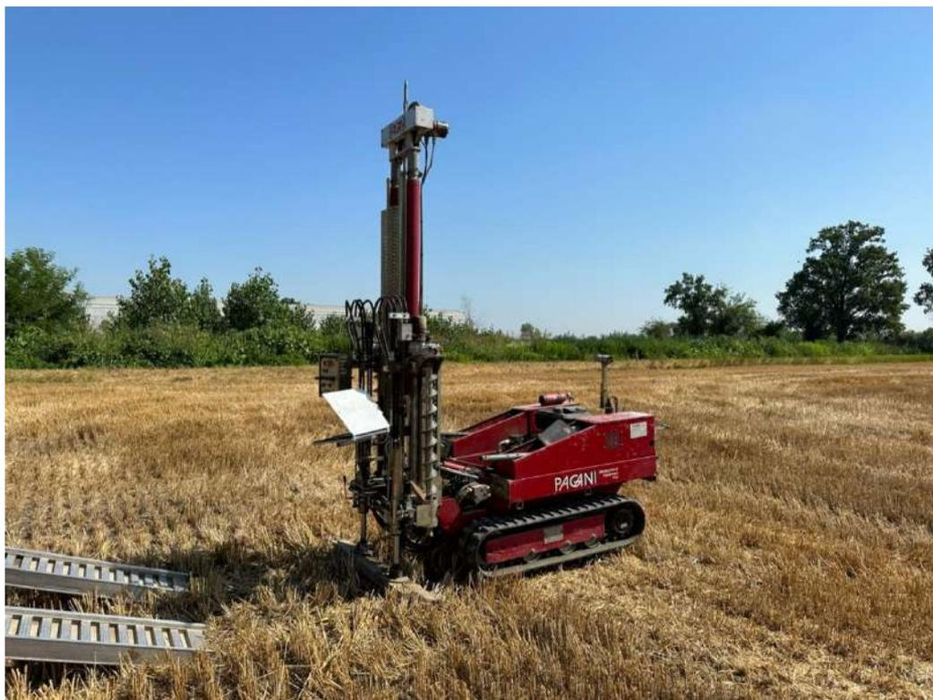
Figura 22: Postazione prova DPSH 01
