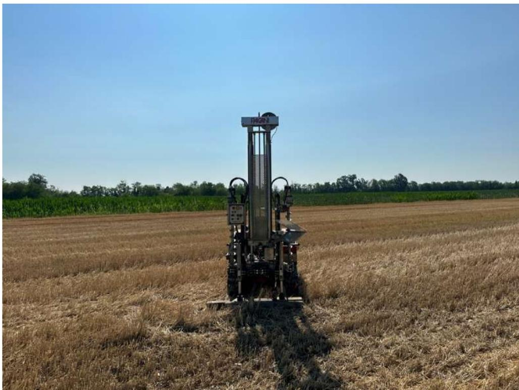
Figura 24: Postazione prova DPSH 03
