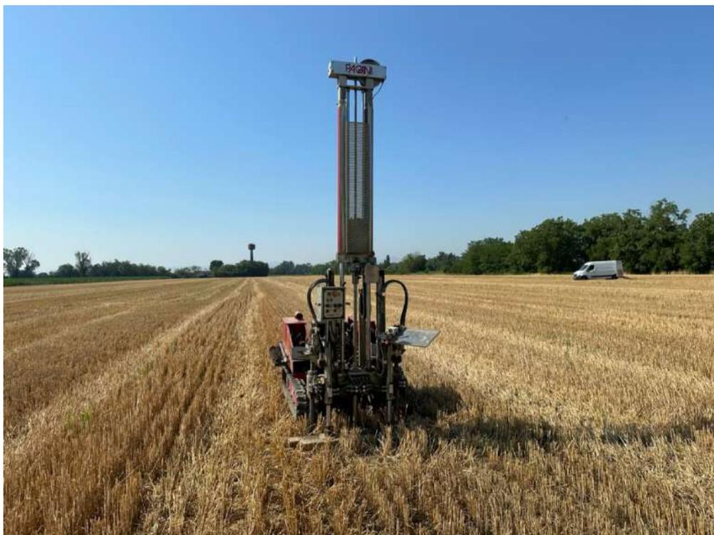
Figura 17: Ubicazione prove penetrometrica statica CPT
