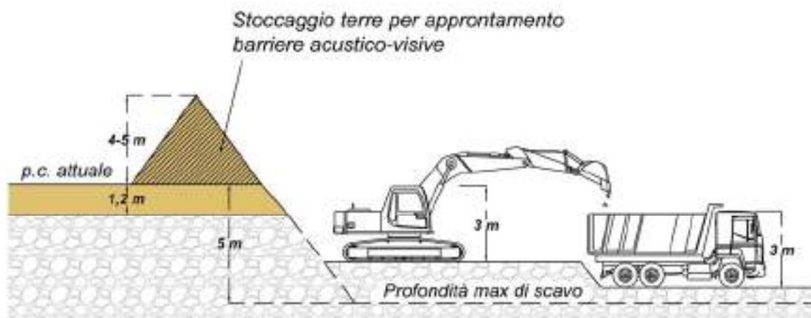
Fig. n°46: La geometria degli scavi in riferimento alle barriere schermanti in progetto
