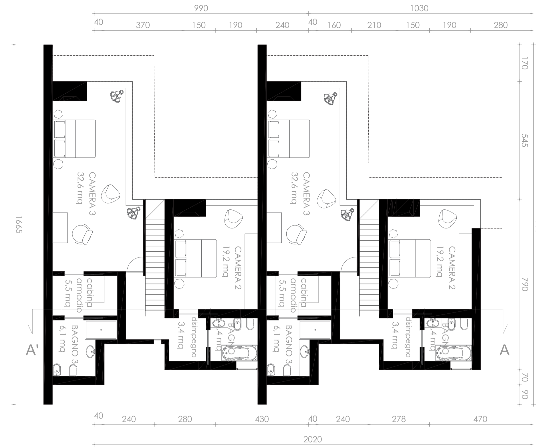
COMPLESSO A SCHIERA (2 unità) - Pianta piano primo
